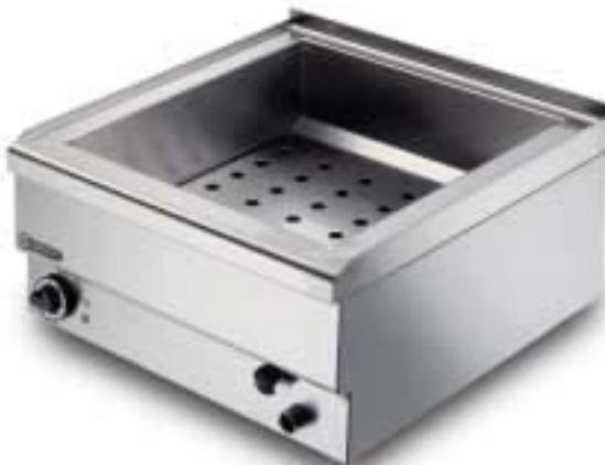
Vasca adatta a contenere bacinelle GastroNorm con altezza max 15 cm. Completa di falsofondo forato e rubinetto di scarico frontale. Fondo inclinato verso lo scarico per un completo drenaggio dell'acqua. Modelli elettrici con controllo termostatico della temperatura (30-90 °C), termostato di sicurezza, resistenze corazzate e spie luminose di accensione. Modello a gas con accensione piezoelettrica e sicurezza garantita da valvola termostatica.
