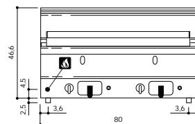
Dotata di bordi paraspruzzi perimetrali e griglia di cottura inclinabile per una cottura più facile ed efficace. Accensione piezoelettrica e sicurezza garantita da rubinetti valvolati con termocoppia e fiamma pilota. I grassi e gli oli vengono convogliati in appositi cassetti raccolti grassi facilmente estraibili per la pulizia. Bruciatori in acciaio a fiamma stabilizzata. Su richiesta griglia per carni.
